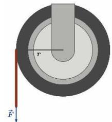
4. Un cilindro pieno, che ruota intorno al suo asse di simmetria con velocità angolare uguale a 150 rad/s, è soggetto a un momento sull'asse di intensità 10 Nm. Se il raggio del cilindro misura 60 cm e la sua massa è pari a 120 kg, quanto tempo impiega per fermarsi? (Esprimi il risultato in minuti)
