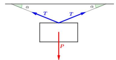
Dimezzando la massa dell'oggetto, si dimezza anche la tensione, visto che è direttamente proporzionale alla massa.
