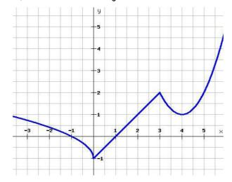
La prima parte del grafico è una parabola con asse di simmetria parallelo all'asse x di vertice V(0; -1) e passante per il punto dell'asse x di ascissa – 1. Per determinarla, consideriamo il fascio di parabole passanti per V e tangenti all'asse y e imponiamo il passaggio del fascio per il punto dell'asse x di ascissa – 1:
