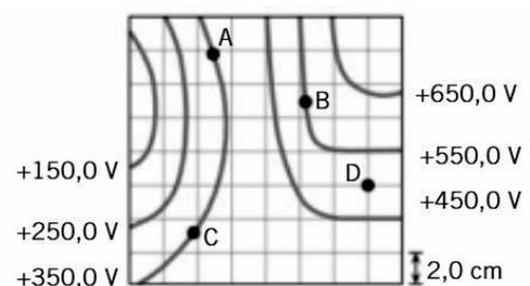
8. Il potenziale nel punto A è  $452\text{ V}$ . Una particella carica positivamente è lasciata libera in A e raggiunge il punto B con una velocità  $v_B$ . Il potenziale nel punto C è  $791\text{ V}$ . Quando la particella è lasciata libera in C, raggiunge B con una velocità doppia rispetto a quella precedente. Calcola il potenziale in B.
